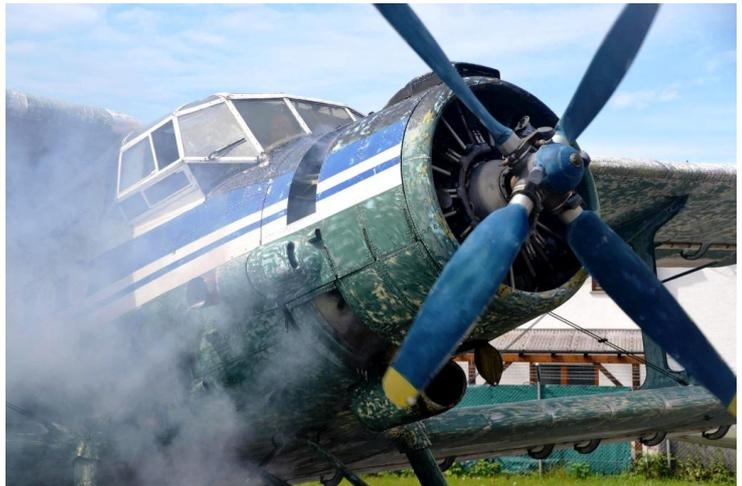
der knapp 30 Liter 9 Zylinder Sternmotor bei 2200 U/ min seine 1000PS entfaltet. 180 Liter Sprit und knapp
